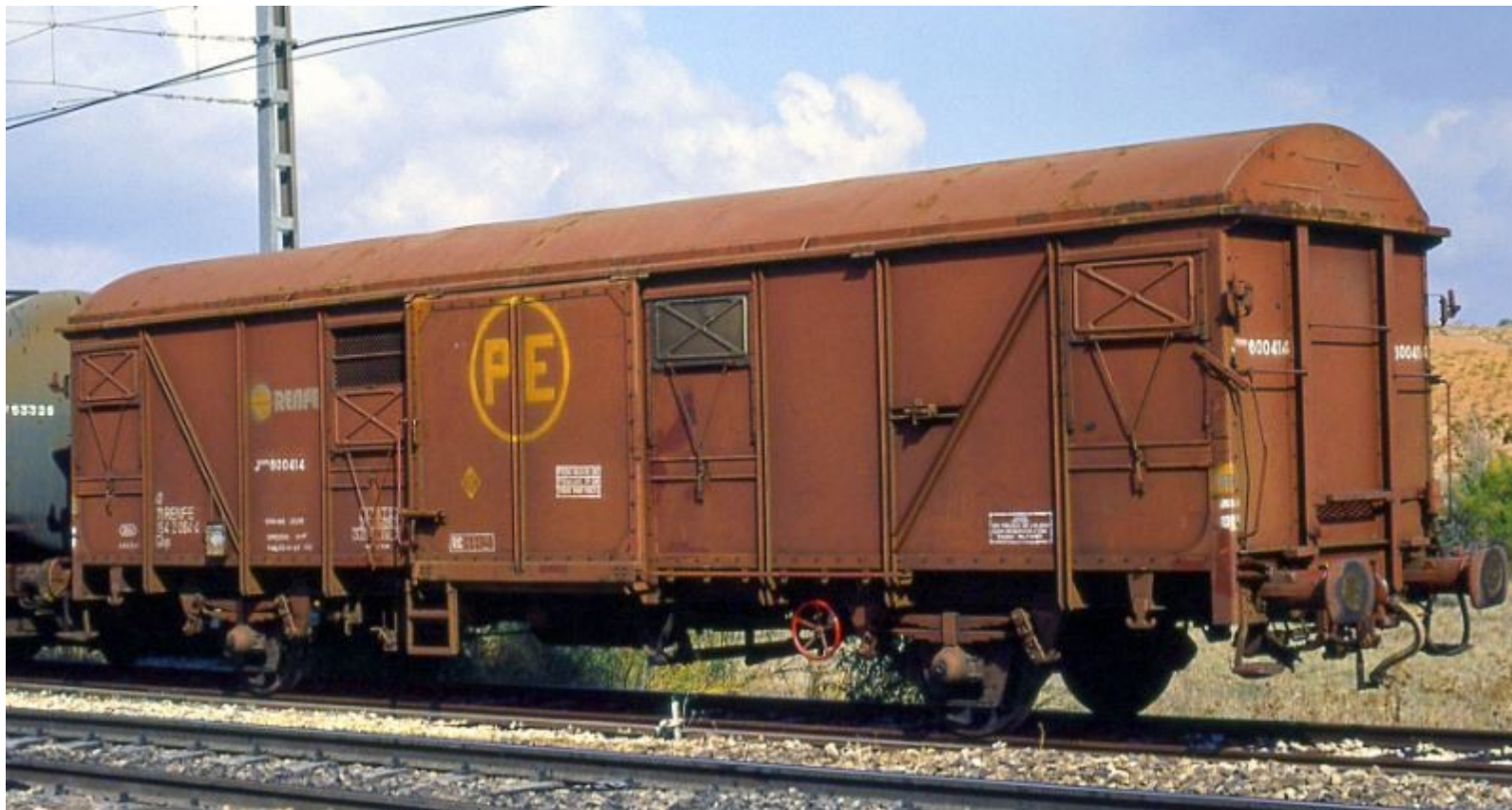
Un vagón ORE-1 con las siglas PE actuando como aislante de una composición de cisternas. Foto: M.Orozco
